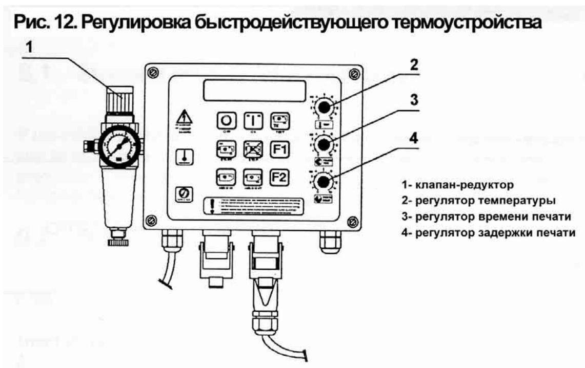
Точная регулировка БТУ достигается благодаря окончательной установке давления печати, температуры и времени печати.
