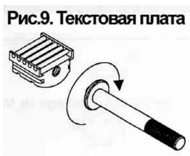
Текстовая плата имеет поверхность печати 12 × 24 мм. Она имеет специальное сечение. Обратная сторона текстов и логотипов имеет такое же сечение.
